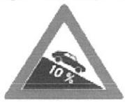
2) Indicatorul alaturat se amplasează la 100-200 m de sfârșitul sectorului de drum, când pantă depășește 7%.
