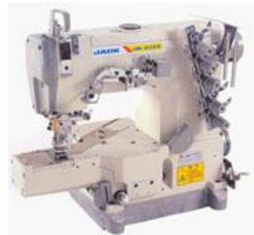
Mașină de cusut cu două sau trei ace, cu cap de coasere clasic pentru cusătură de acoperire
