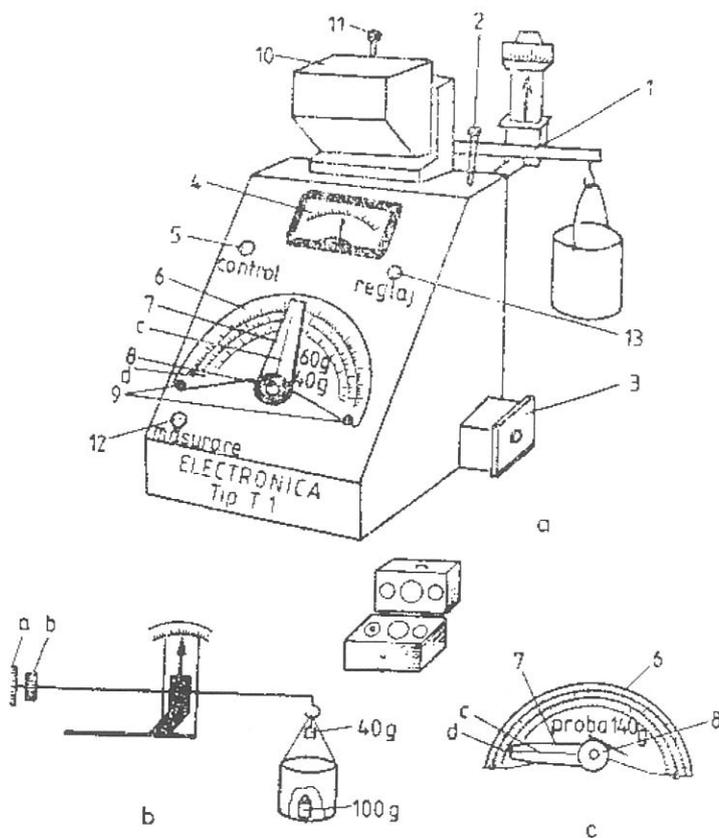
1- sistem de cântărire; 2- buton de golire; 3- sertar; 4- instrument de măsură; 5- buton de control; 6- semidisc; 7- indicator; 8- buton central; 9- opritor; 10- pâlnie; 11- buton de alimentare; 12- buton de măsurare; 13- buton de reglaj
