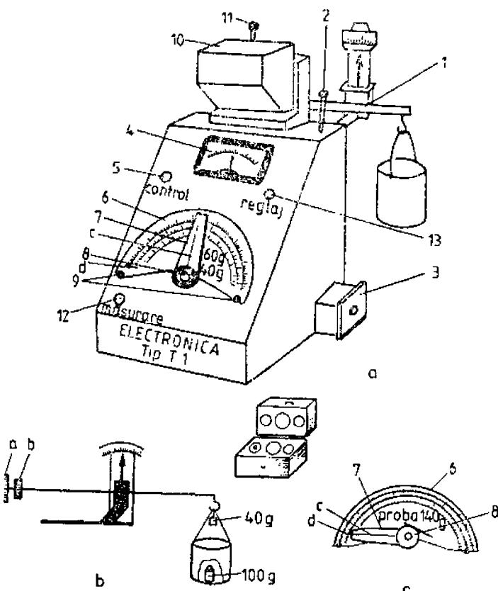
1- sistem de cântărire; 2- buton de golire; 3- sertar; 4- instrument de măsură; 5- buton de control; 6- semidisc; 7- indicator; 8- buton central; 9- opritor;
