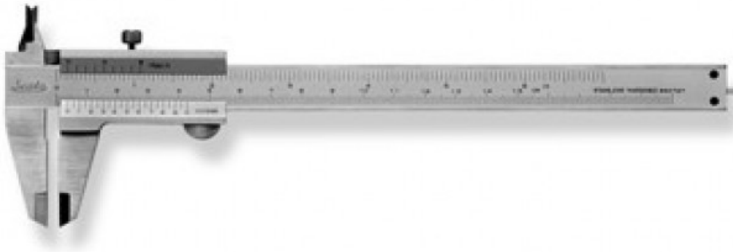
Fig.5 Șubler de interior și exterior cu limita inferioară de măsurare 0
