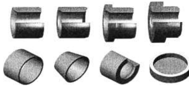
Fig.1 - Forme diferite de bucșe
